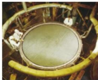
Pt-Rh katalizátor háló Az Ostwald folyamatban
